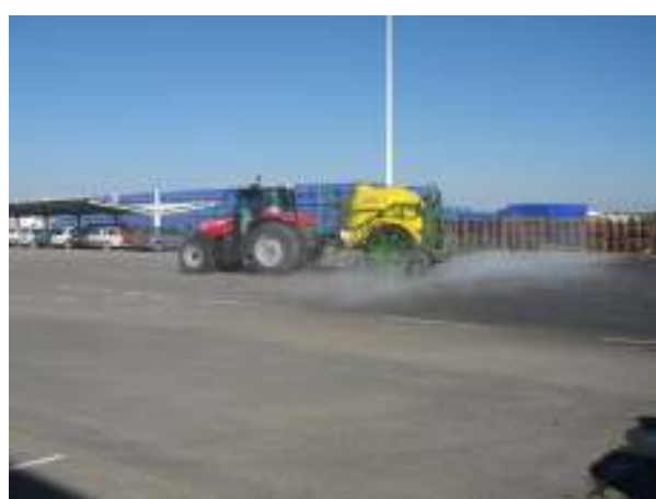
Prueba del pulverizador con agua sobre asfalto
