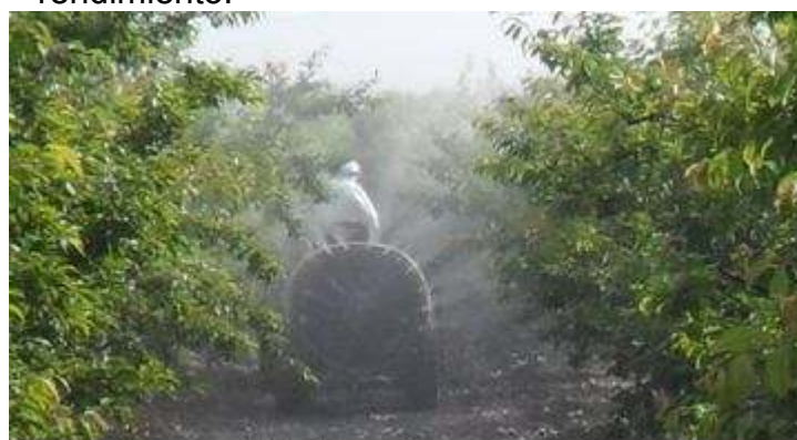
Atomizador con ventilador tipo axial.
