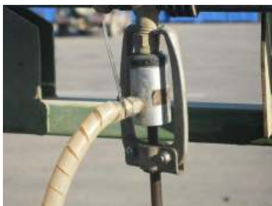
Sistema para recogida de caudal emitido por cada boquilla.
