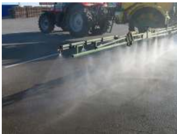
Barra de pulverización a inspeccionar. Se aprecia el buen solape obtenido por las boquillas de abanico.
