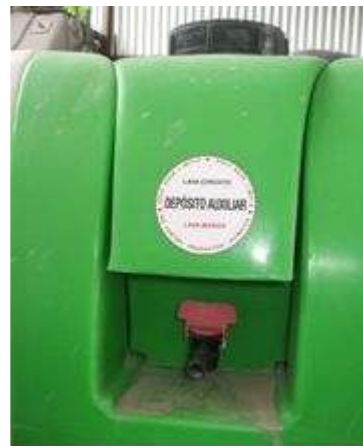
Deposito uso operador
