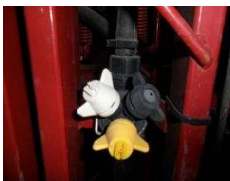
Revolver de boquillas sobre barra distribuidora
